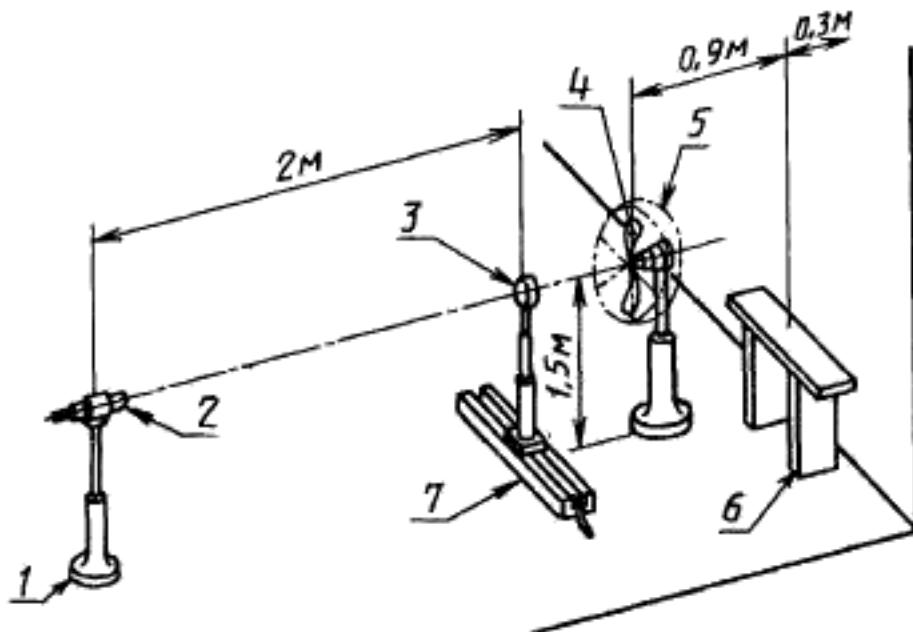
1 — положение наблюдателя; 2 — телескоп; 3 — анемометр; 4 — испытуемый вентилятор; 5 — защитное ограждение; 6 — столик для измерительных приборов; 7 — подставка для анемометра
