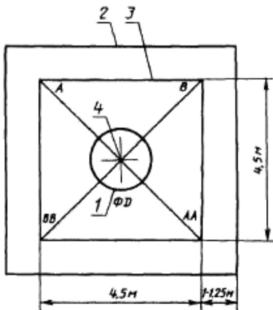
1 — верхнее отверстие; 2 — внешний экран; 3 — испытательная камера; 4 — вертикальная ось вентилятора
