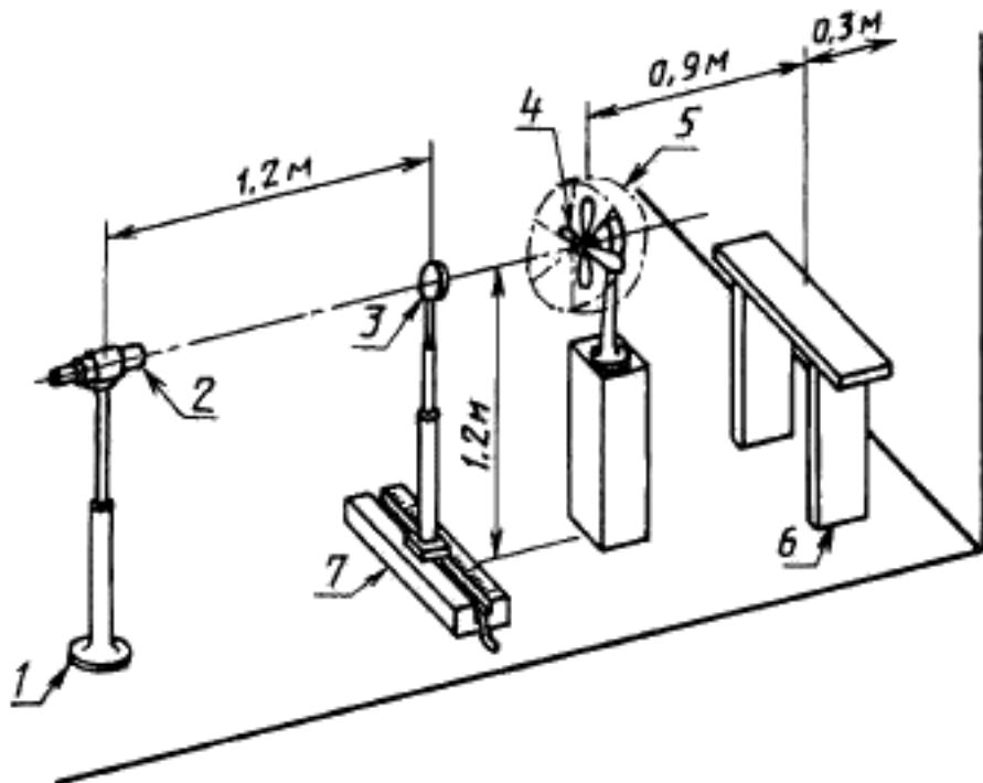
1 — положение наблюдателя; 2 — телескоп; 3 — анемометр; 4 — испытуемый вентилятор; 5 — защитное ограждение; 6 — столик для измерительных приборов; 7 — подставка для анемометра
