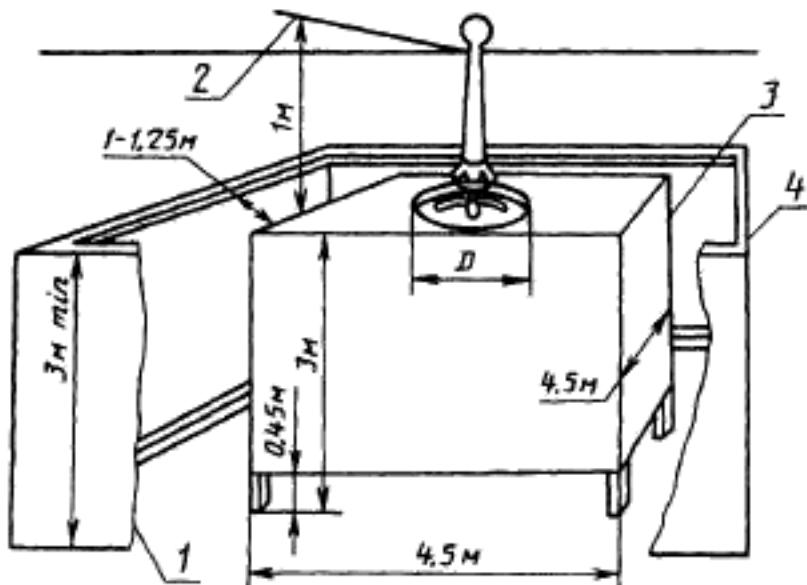
1 — внешний экран в разрезе для показа отверстия внизу испытательной камеры;
